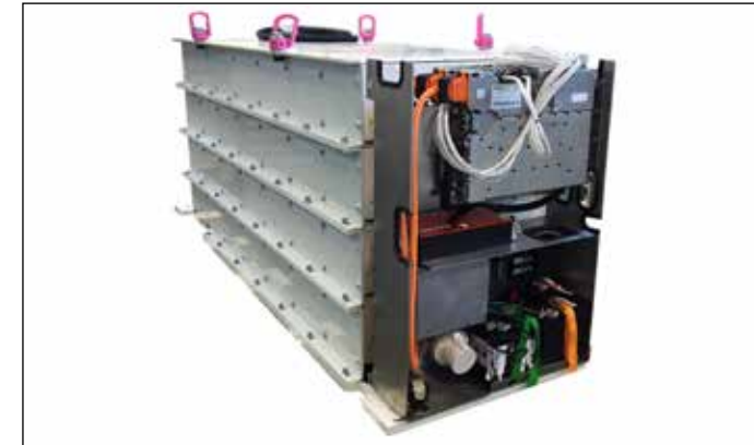
Lithium-Ionen-Batterie-Baugruppe bereit für die Montage am Bagger.
